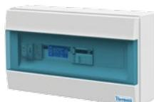
**TKR BOX (43753)** - Каскадный регулятор TKR встроенный в монтажную коробку 1x18 модулей представляет собой комплект для управления 2-мя или 3-мя котлами в каскаде (размеры коробки позволяют расширить до 8-ми котлов) и предусмотрен для установки на стену рядом с котлами. В комплект входит встроенный источник питания, дисплей, контактор для управления сетевым насосом, выключатель и предохранитель, датчик каскада, датчик наружной температуры, шина коммуникации и 3 блока коммуникации с котлами.
