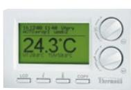
**PT59X** (43506) - Программируемый комнатный регулятор с самым высоким уровнем управления. Недельная программа, коммуникация, эл. питание от котла. Поддерживает настроенную температуру в диапазоне до 0,2 град., заранее включает отопление, эквивермическое регулирование, можно подключить модуль GSM 1 для управления по SMS. Подходит к электрокотлам и котлам КОМФОРТ марки THERM.
