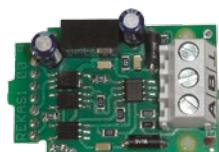
**REKAS 1** (42188) - Интерфейс для каскадного подключения до 32 электрокотлов THERM EL. В каждом котле используется один интерфейс, отдельные интерфейсы подключаются параллельно, 3-х жильным проводом. Все параметры и данные устанавливаются только на одном, ведущем котле, а остальные, ведомые котлы каскада работают по информации, выдаваемой ведущим котлом.
