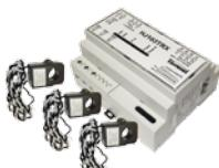
**HJ103TRX** (43518.1) - реле разгрузки (ограничения тока). Реле контролирует эл. нагрузку на весь дом (квартиру) и в случае превышения эл. тока снижает мощность любого эл. котла THERM EL.
