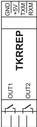
На выходе из блока находятся два независимых реле контактов, которые работают согласно настройке переключателей модуля TKR REP.
