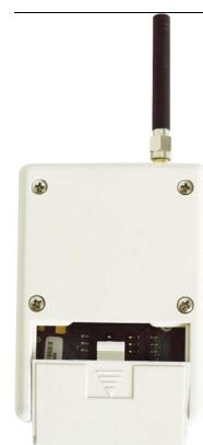
5. Присоедините модуль GST1 к регулятору PT55X (или к модулю MS1) информационным кабелем (прилагается). При недостаточности длины кабеля, используйте новый кабель необходимой длины с установленными штекерами (приобретается отдельно). Прокладку кабеля необходимо производить в отдельных коробах (штробах) на расстоянии не менее 100мм от электропроводки. **Установка соединительных муфт для удлинения кабеля и прокладка совместно с электропроводкой не допускается!!!**
