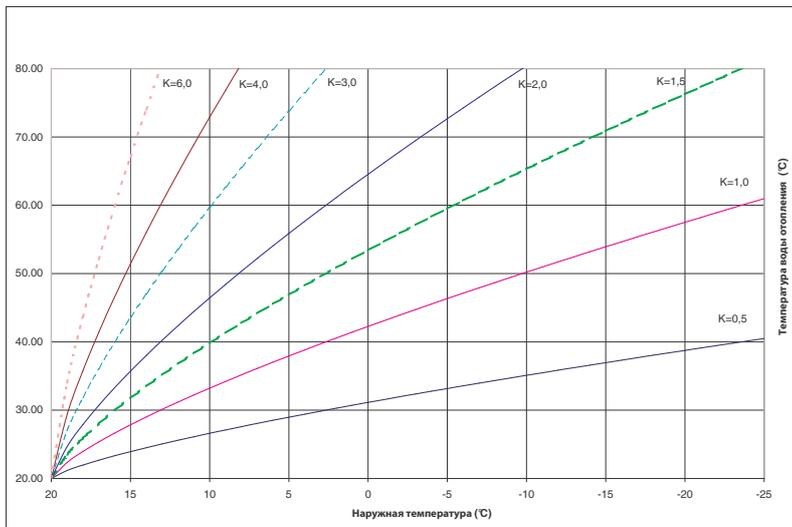
Рассчитанная температура воды отопления ограничена макс.  $80^\circ\text{C}$ . Если рассчитанная температура колеблется в диапазоне  $20 \div 35^\circ\text{C}$ , то требуемая температура ограничивается минимальной температурой котла - т.е.  $35^\circ\text{C}$  и включается функция периодического запуска котла с фиксированным интервалом 15 минут и переменным временем работы до  $35^\circ\text{C}$  по формуле:
